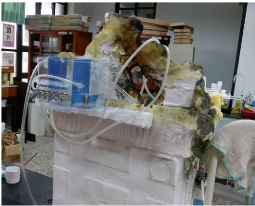
說明:安裝打氣與分流管路
