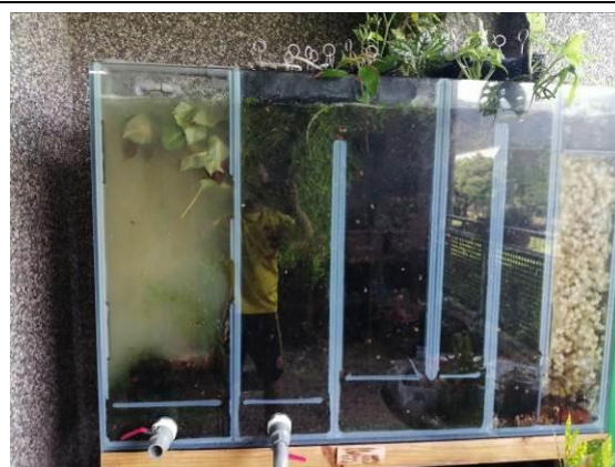
說明:將過期牛奶倒入，測試「校園生廚餘活菌液肥系統」處理奶類廢液能力
