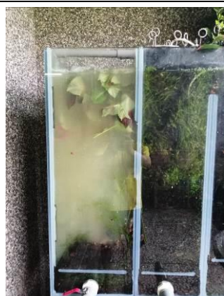
說明:將過期牛奶倒入，測試「校園生廚餘活菌液肥系統」處理奶類廢液能力
